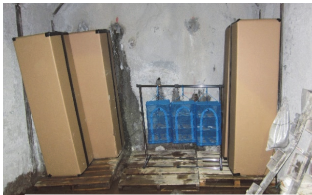
写真 3 耐候性試験用の箱状試験体および試験状況
