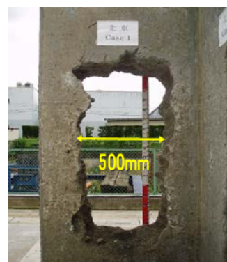
写真-6 切削スリット (放射, 0.6N/mm 2 )
