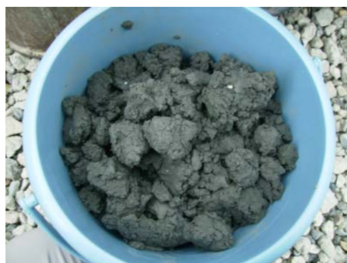
写真-6 消泡後の掘削土
