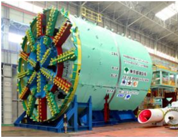
写真-2 φ12.53m 泥土式シールドマシン
