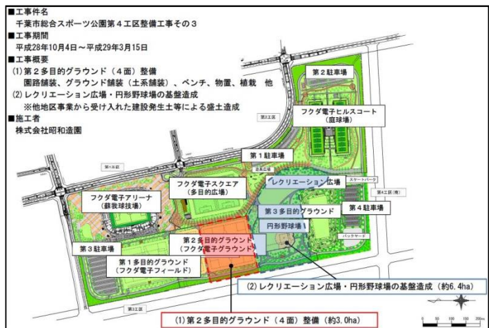
図 2 平成 28 年度整備工事概要
