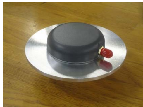
写真 2 GNSS アンテナ
