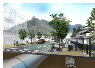
▲電線共同溝と地下貯留槽の整備イメージ
