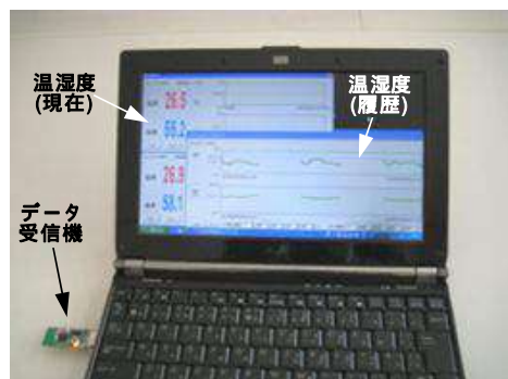
写真4 データ受信機およびモニタリングソフト画面 [ 設計・開発協力: ミツミ電機 ]
