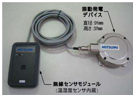
写真1 振動発電デバイスと無線センサモジュール [設計・開発協力:ミツミ電機]
