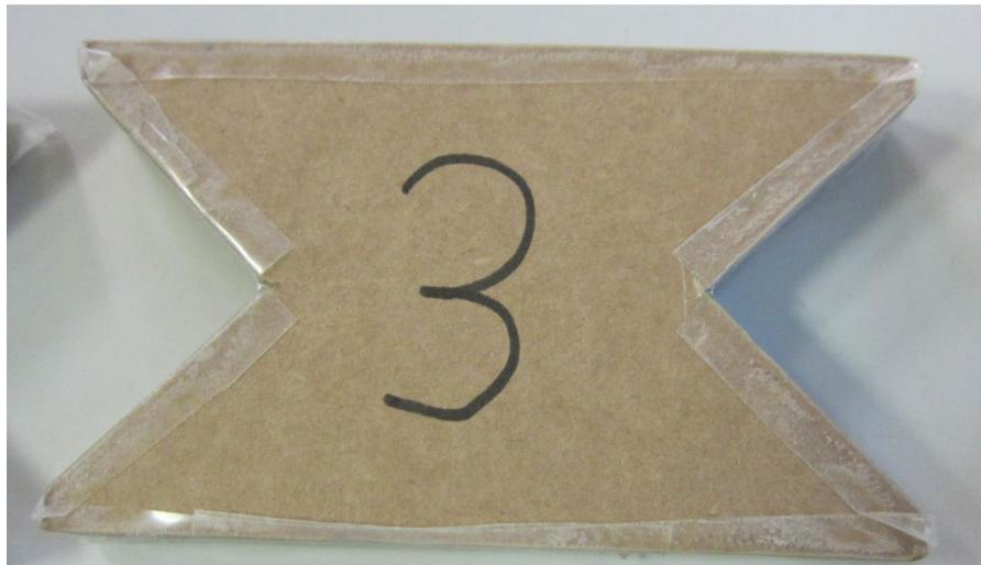
圧縮強度試験体：木端口をテープ養生
