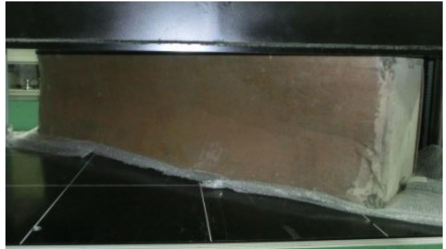
箱状試験体の圧縮強度試験
