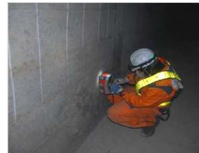
詳細健全度点検(数橋/年) 目視できない構造を、非破壊 検査などで確認
