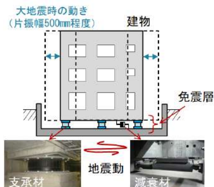
図 1 免震建物の概要
