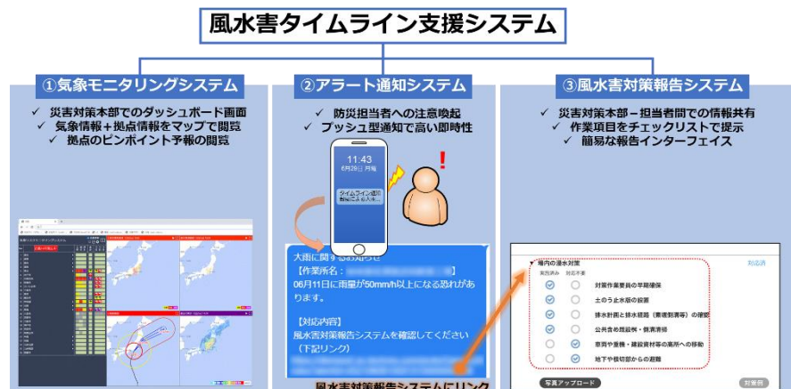
図1「風水害タイムライン支援システム」の構成
