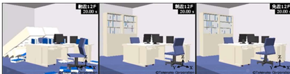
図 5 耐震、制振、免震の比較動画
