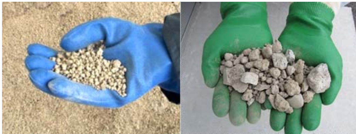
写真-11 造粒物(左)と造粒再生砕石(右)
