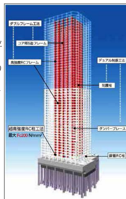
図-5 超高層住宅構造システムイメージ
