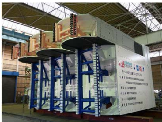
写真5 新日比谷通路新設 泥土圧推進機(R-SWING工法)
