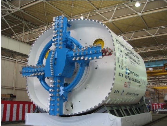
写真1 上野地下歩道者専用道 泥土圧シールド機(EX-MAC 工法)
