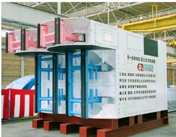
写真3 新御茶ノ水駅連絡出入口 泥土圧推進機(R-SWING 工法)
