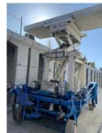
写真 4: 横引き工法(リフトローラー)
