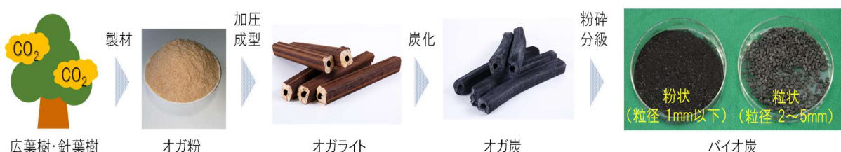
図1 本検討で使用したバイオ炭の製造過程
