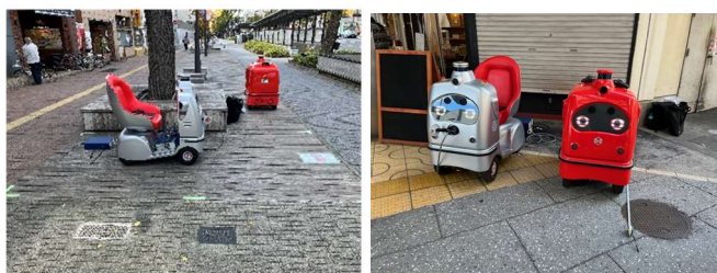
図11 歩道(ほこみち空間)におけるロボットの停留状況(左) 商店街内の店舗前における充電状況(右)
